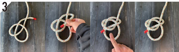
3 ぐらせた後は先端じゃない方のロープをくくり、また先端を輪に戻します。
