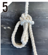
5 この状態でもトラック結びはできますが、より解けにくくするためにUの字を『もやい結び』のようにします。こうすることで解けにくくなり、もやい結びのように解くことも容易です。
