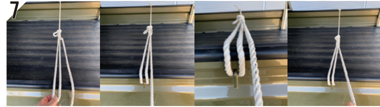
7 通した輪の部分を引っ張って、反対側のフックにかけます。そして先端を引っ張ると抵抗はありますが3倍ぐらいの力で引けます。
