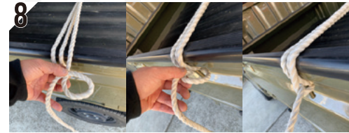
8 このままでは手を離すと緩んでしまうので、写真のように「の」の字の反対のように作り、フックにかけて締めます。
